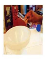
Ajouter le glycérol en utilisant un cylindre gradué. Le glycérol étant une substance visqueuse adhérant aux parois, rincer le cylindre avec un peu d'eau distillée ou d'eau bouillie refroidie, et verser le contenu dans la bouteille, le réservoir ou le récipient servant au mélange.
